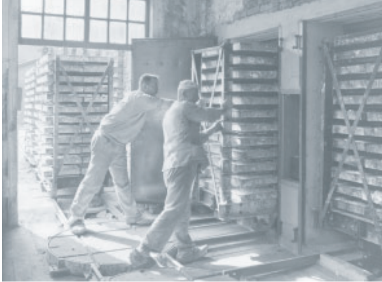
Erst Aufnahmen aus dem Jahr 1935 geben einen Eindruck von der Bleiweiß-Produktion. Hier wird gerade ein Trockenofen mit Bleiweiß beschickt.
