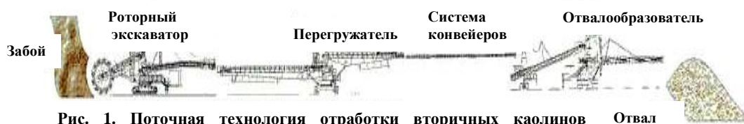
Рис. 1. Поточная технология обработки вторичных каолинов (вскрышные работы) производительностью 4,5 млн. куб м в год
