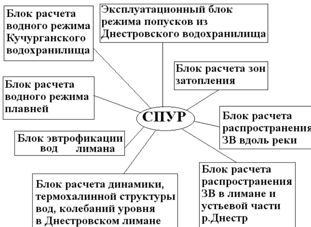
Рис. 1. Блок-схема СПУР
