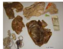
5 Kunstleder der Rückenleh- ne, Detail; hoher Abbaugrad hinter dem Sitz des Fahrers
