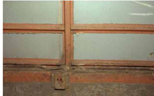
1 Griff der Tür am Heck; Rostläufer waren tief in die oberste Lackschicht eingezogen (Foto Jehle)
