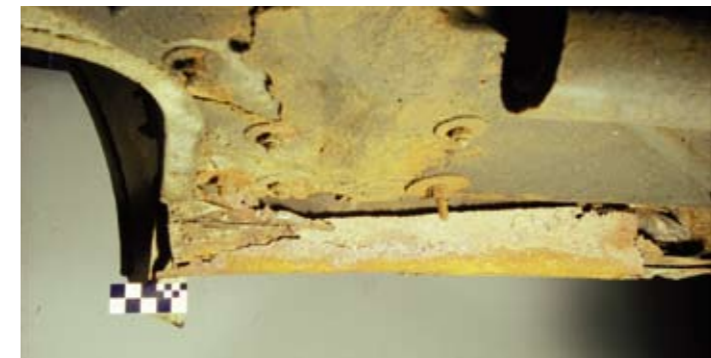
11 Unterboden der Fahrerkabine, Detail des durchgefalten Holzes, ummantelt von korrodiertem Blech. (Foto Berlin)
