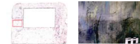
7 Probereinigung des Balatum: die öligen Überlagerungen wurden soweit abgetragen, dass das Bild eines gebrauchten gepflegten Zustands entsteht. (Foto Garve)
