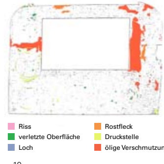
4 Bodenbelag im Laderaum, Bereich um die Motorabdeckung herum; Bemaßung in Zeichnung. (Zeichnung Garve)
