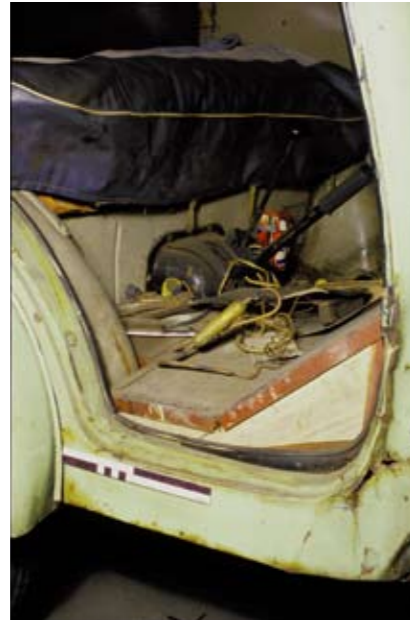
1 Griff der Tür am Heck; Rostläufer waren tief in die oberste Lackschicht eingezogen (Foto Jehle)
