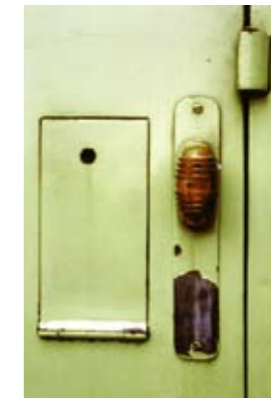
10 Ersatzrad; in Übereinstimmung mit dem Schliffbild: unter der nicht durchgängig aufgetragenen obersten Lackschicht liegt das dunkle Blau.
