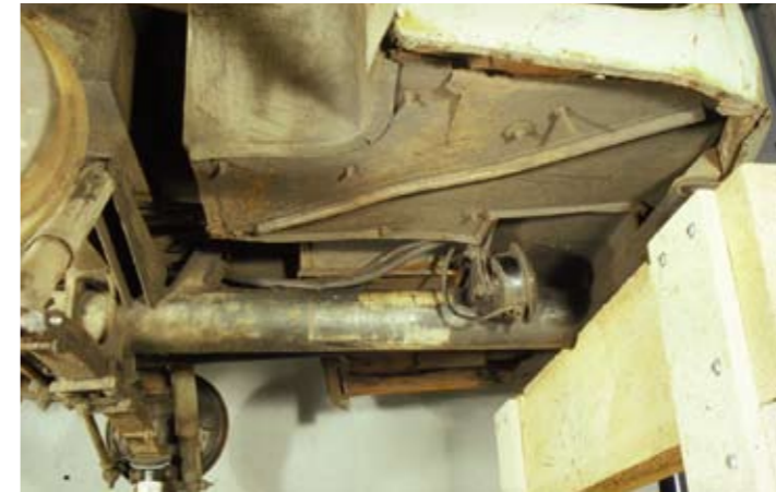
10 Fahrerkabine in kombinierter Holz- Stahlkonstruktion von unten, vor der Vorderachse liegend, Zentralrohrrahmen, davor die Signallhornanlage, die Bodenbleche durch Sicken verstärkt; das mit Blech ummantelte Holz im Kantenbereich stark abgebaut. Gutbrod hatte eine lange Entwicklungszeit in den Motor gesteckt und die Karosserie relativ kurzfristig von der Firma Binz bauen lassen. Der gleichzeitig produzierte VW Transporter hatte eine durchgehende Ganzstahlkarosserie. (Foto Berlin)
