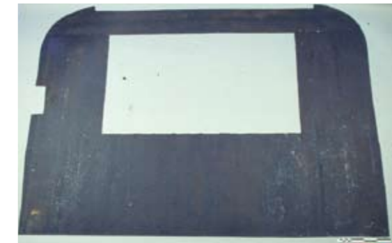
8 Rückseite des Bodenbelags aus mit Bitumen getränktem Filzmaterial (Foto Garve)
