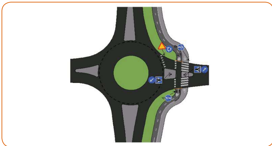
Figur 16. Typritning cirkulationsplats-med cykelöverfart och övergångsställe. Bild lånad från rapporten Säkrare cykelpassager - Gatubolaget.
