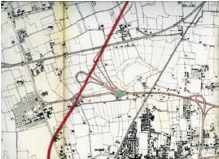
**39.** 1960, 5 maggio. Progetto di massima dell'ing. E. Galletti della tangenziale autostradale a regime chiuso, con sistema di complanari separate. Si tratta del primo e ufficiale progetto, dato che quello approvato e realizzato sarà steso solo nel 1968. L'estratto qui riprodotto riguarda il nodo di raccordo con il tratto finale della circonvallazione est di Mestre - interposta tra il forte e il
