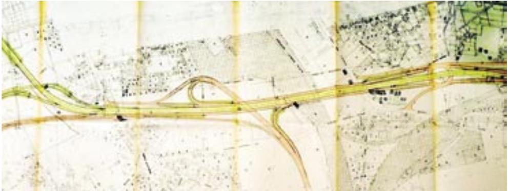
**41.** 1960, 5 maggio. Progetto di massima dell'ing. E. Galletti della tangenziale autostradale a regime chiuso, con sistema di complanari separate. Particolare della tratta tra il raccordo delle complanari con il cavalcavia di Mestre- Marghera e quello con la strada miranese.
