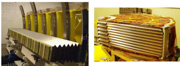
Рис.4.4. Фотографии секторов барреля (справа) и торцевого (слева) EM калориметра детектора ATLAS. Ось пучка на левом снимке направлена вверх. На правом снимке видны
