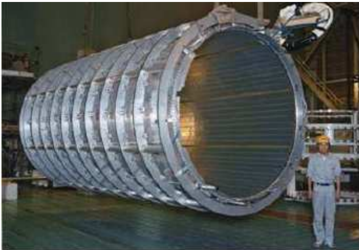
Рис.2.4. Внутренний соленоид детектора ATLAS в производственном помещении после завершения намотки катушек.
