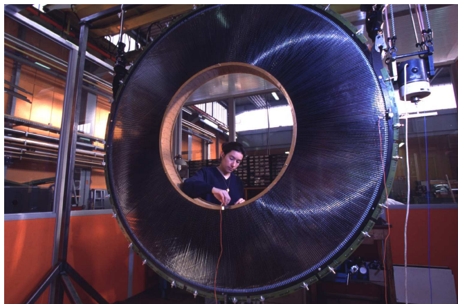
Рис.3.15. Монтаж колеса торцевой части Детектора переходного излучения ATLAS.
