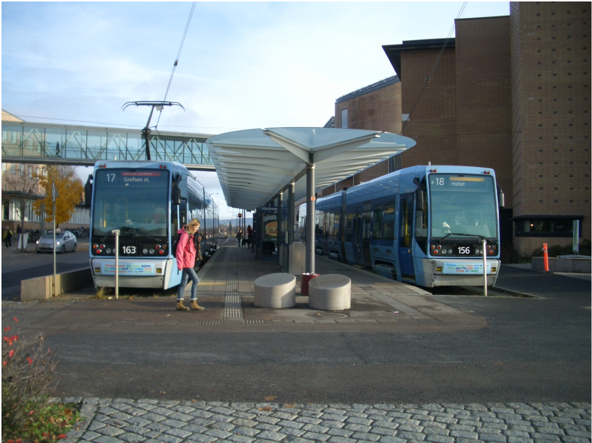
Foto 8: Eksempel på ø-perron på terminal. Endestation for linjerne 17 og 18 på Rikshospitalet i Oslo oktober 2011.
