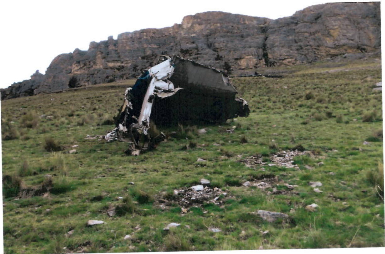
Sección de la cola del OB-1887-P, en cuyo interior fueron encontradas las dos grabadoras de voz CVR y de datos FDR.
