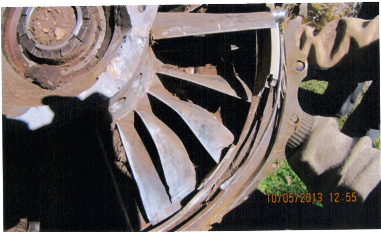
Motor N° 1, con deformación en el eje longitudinal de los álabes de compresor por el impacto a tierra sin rotación.
