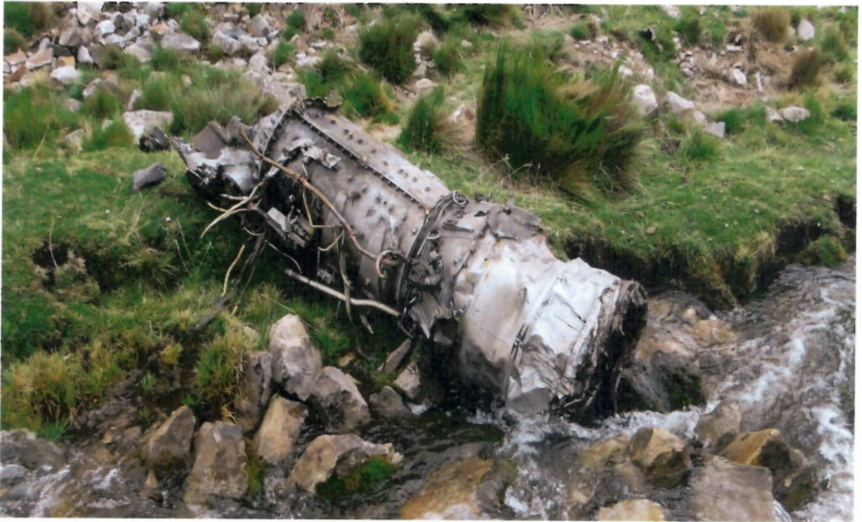
Motor N° 1 destruido por impactos contra el terreno sin caja reductora
