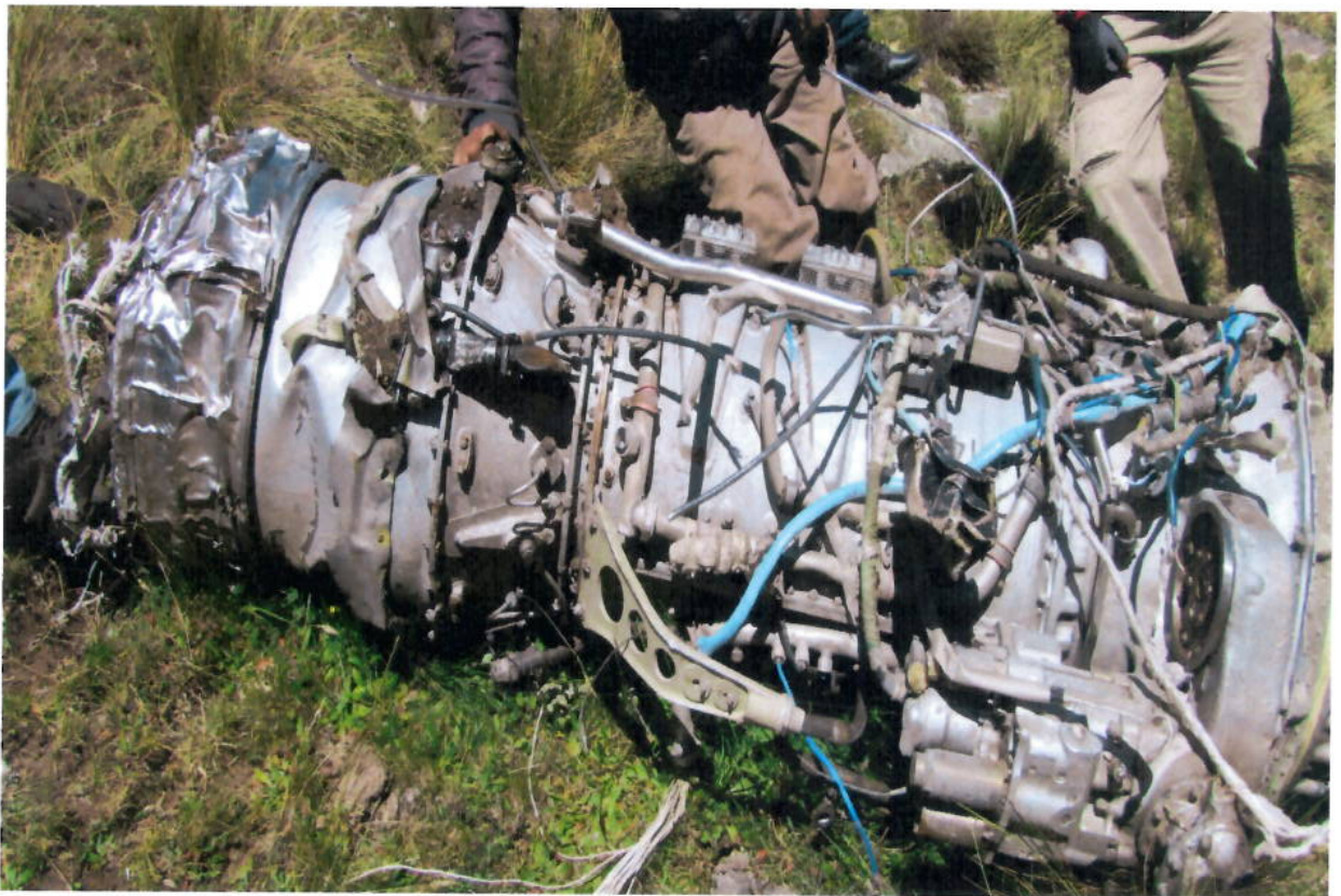
Motores N° 2 destruido por impactos, sección de turbina deformada
