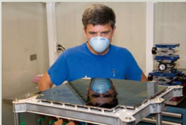
圖四：Pan-STARRS的Gigapixel相機。 (圖片來源： http://pan-starrs.ifa.hawaii.edu/public/design-features/camera-small.htm )
