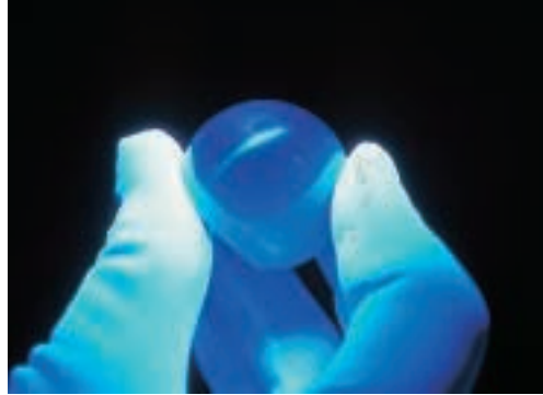
Künstliche Hüftgelenk- kugel aus Aluminiumoxid- Keramik
