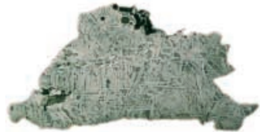
Angeätzter Eisenmeteorit mit Widmanstättenschen Figuren
