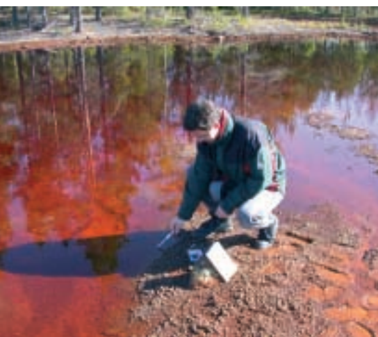
Messung des pH-Wertes in eisenreichen, sauren Minenwässern unterhalb einer Abraumhalde in Kristineberg, Schweden
