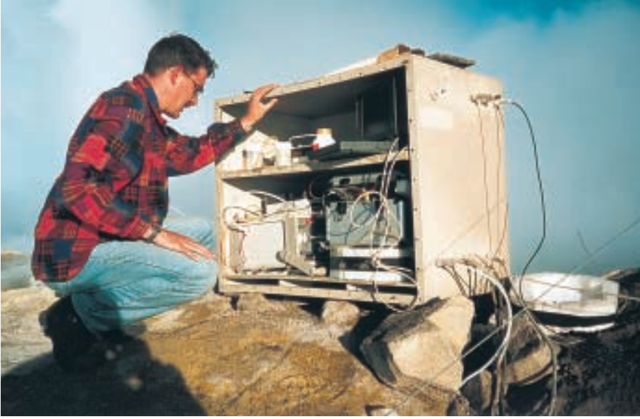
Messgerät zur Gasanalyse am Kraterrand des Merapi
