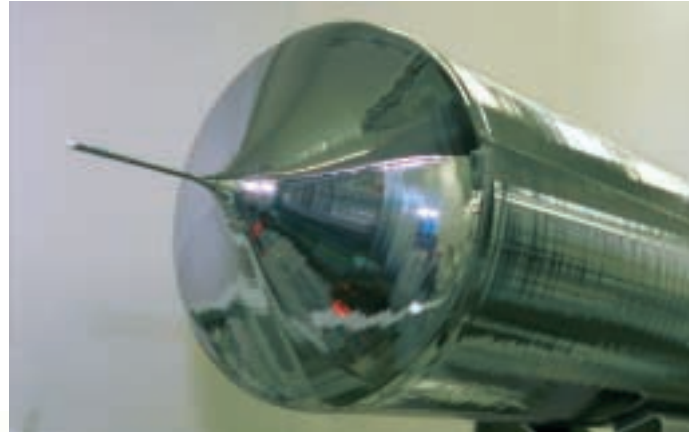
Silizium-Einkristall zur Waferherstellung können heute mit 300mm Durchmesser hergestellt werden
