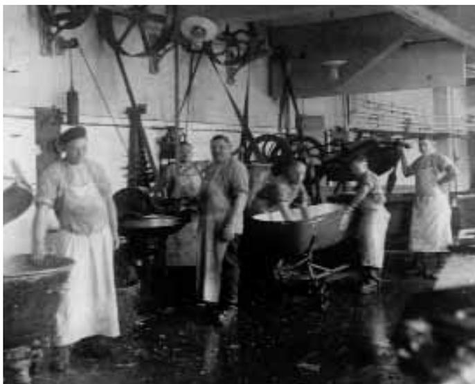
**Industrielle Herstellung der Frankfurter im frühen 20. Jahrhundert. Ein Generator treibt über einen Transmissionsriemen mehrere Maschinen an.**
