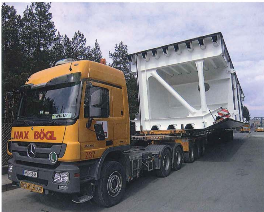
Figur 12. Transport fra værksted til kanaltransport.
