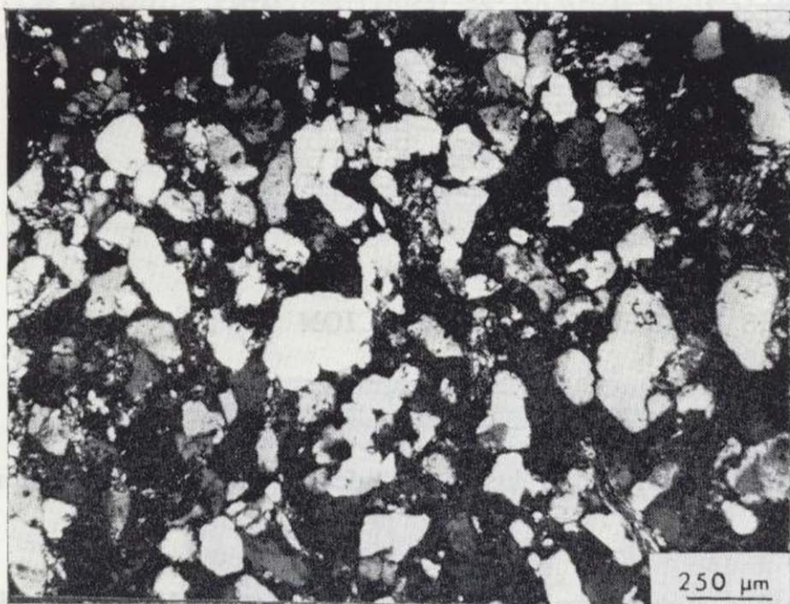
Figura 4.—Aspecto de la textura de la arenisca Carbonífera. Se observan granos de cuarzo, feldespatos alterados, alguna lámina de moscovita y cemento de cuarzo de sobrecrecimiento (N. C.)
