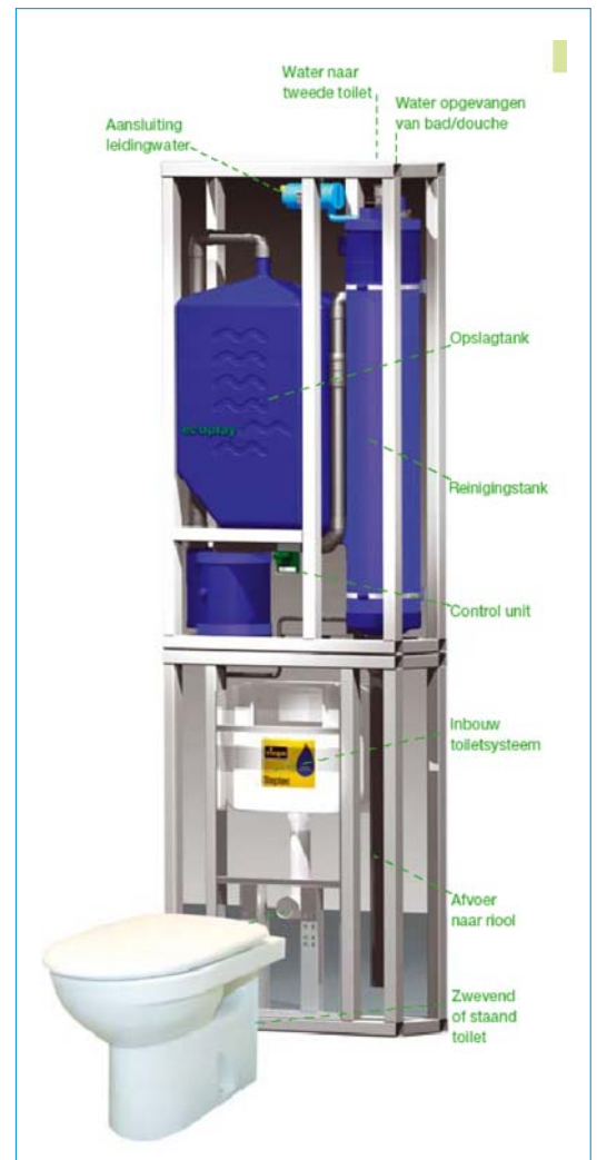
Afb. 39: Hergebruik douche/badwater. In deze verdiepinghoge prefab unit wordt water afkomstig van douche en bad gereinigd en vervolgens opgeslagen in een tank van 100 liter. Dit water kan voor toiletspoeling worden gebruikt. Er kan een tweede toilet worden aangesloten. De unit is ook aangesloten op het drinkwaternet zodat er altijd voldoende water van voldoende kwaliteit aanwezig is. Afbeelding: Ecoplay.
