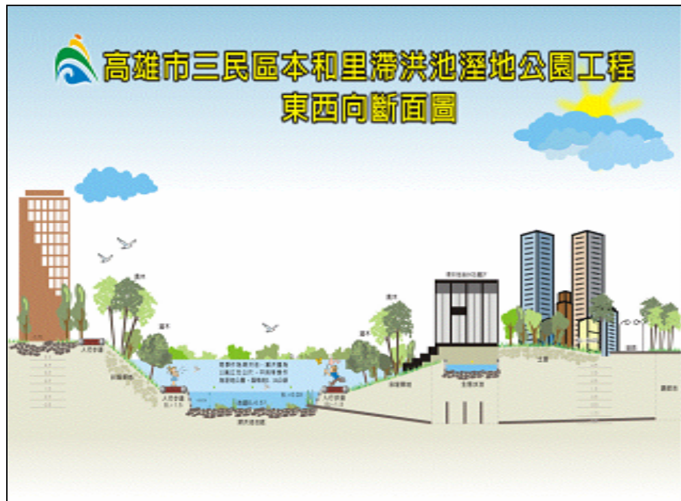
圖 8 滯洪池東西向斷面圖
