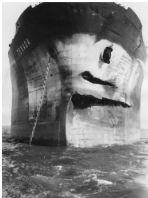
テキサダの船首部に生じた亀裂（海上保安庁提供）
