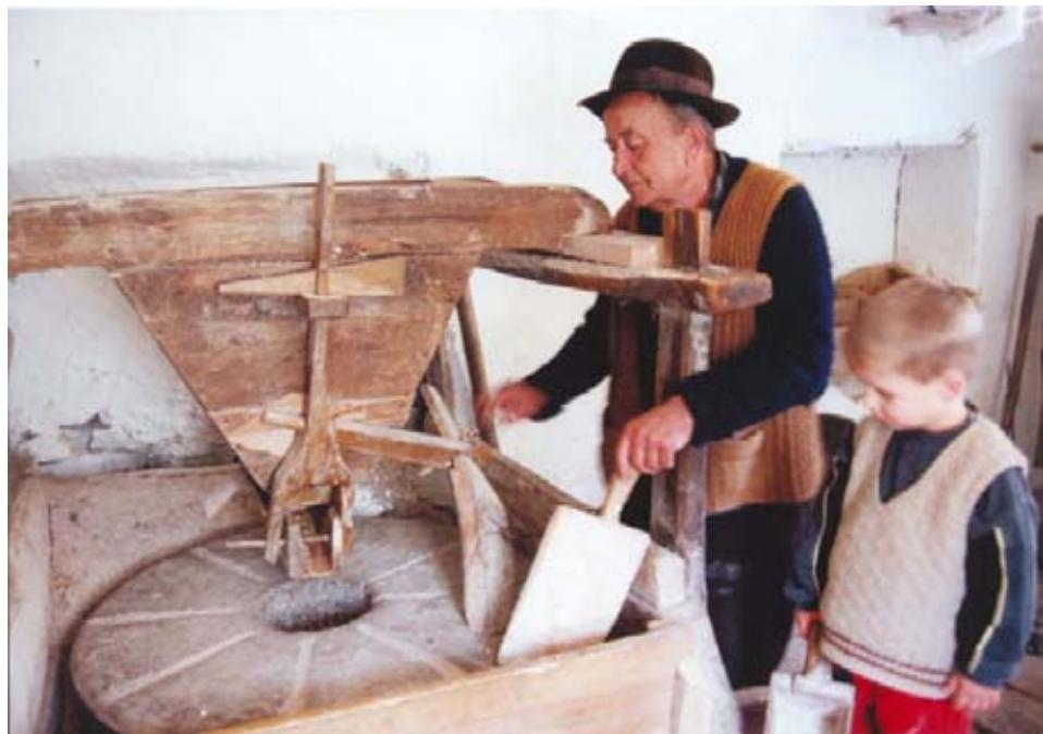
Da bi se u vodenici potočari umlelo brašno prvo mora da se iz reke navrnuti voda u jaz. Iz jaza dolazi voda u bukvu, pa kad se ona ispuni vodom dolazi do cipuna iz koga pod pritiskom udara u drveni točak sa perima, i on se tada pokreće. Taj drveni točak okreće vodenički kamen.
