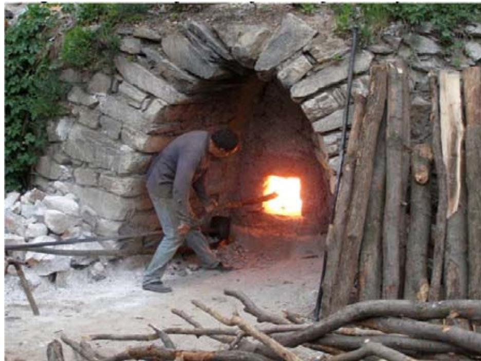
Kada je sve gotovo, krečana se zapali i loži toliko dugo koliko uslovi zahtevaju (kvalitet drva ,vlaga krečane, kiša itd), u zavisnosti od toga ona gori od 36 do 48 sati, u jednom trenutku dostiže temperaturu i do 1700 C (postaje užarena peć u kojoj se zapali kamen krečnjak) krečnjak ima određenu količinu vlage i dok ne ispari ne može da postane kreč.
