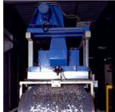
Les flans à la sortie du four de recuit.
