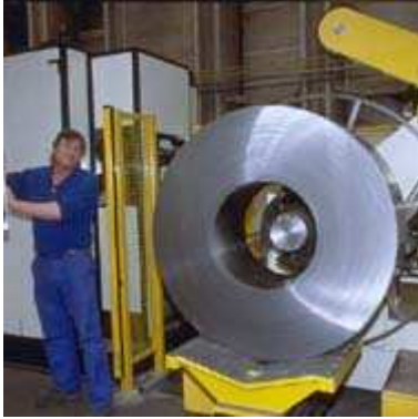
Mise en place d'une bobine d'acier sur la presse à découper.
