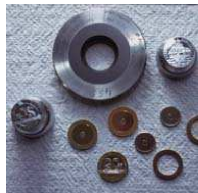
La frappe entre coins et virole assemble couronne + cœur
