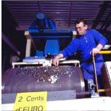
Les flans passent lentement dans le four sur un tapis.
