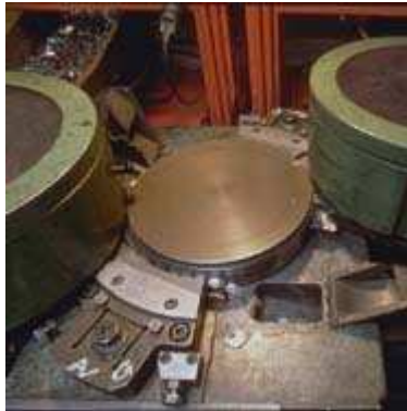
Cordonnage : les flans passent entre un cylindre et un sabot.
