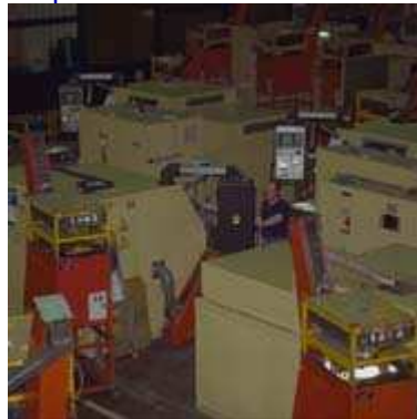
Les presses frappent à la cadence de 800 coups/minute
