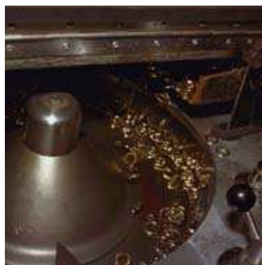
Vibreux qui range les couronnes en tube pour alimenter la frappe
