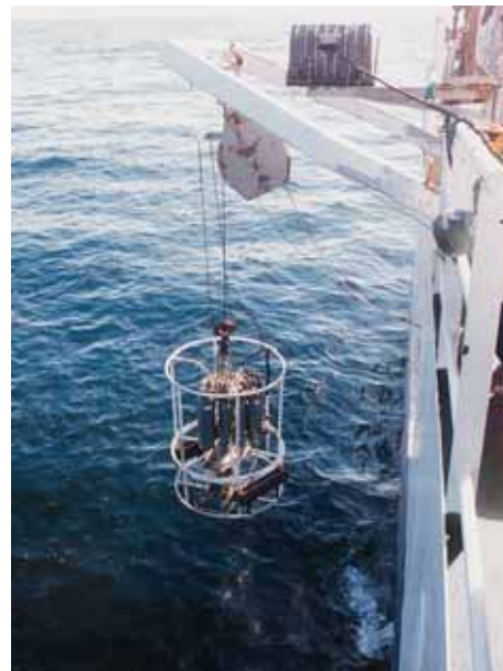
Mynd 2.15 CTD-in á Magnusi Heinasyni við rosettu og fløskum rundanum, klár til at lora niður í sjógvin.
