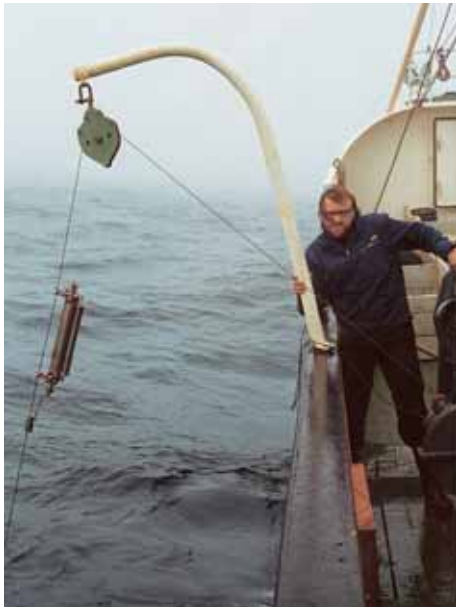
Mynd 2.14 Ein Nansen-fløska verður lorað í sjógvin frá Jens Christiani Svabo í 1973. Veirurin fer um ein blokk við einum teljara, sum vísir; hvussu nógvir metrar av veiri eru úti.
