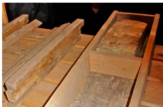
22B. Utställning vid Nivaagårds Ringtegelverk. Träformar och skrapor lika de som kan ha använts i Rydebäck vid utformning av tegelstenar.
