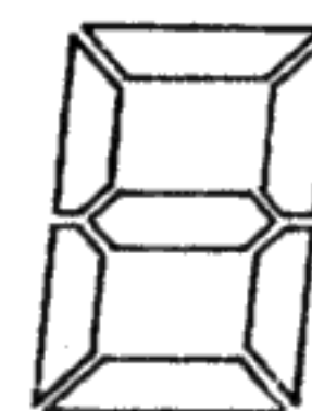
25.23. ábra. Világítódiódákból felépített 7 szegmenses kijelző
