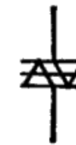
24.9. ábra. Kétirányú tirisztordiódák rajzjele
