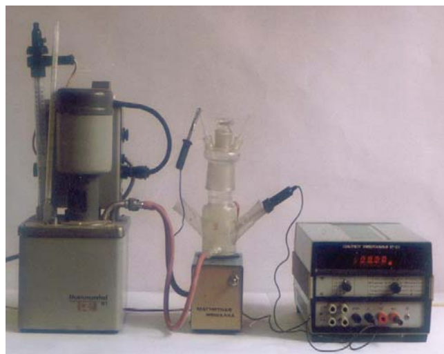
Установка для изучения электронных потенциалов на поверхности остеофиксаторов
