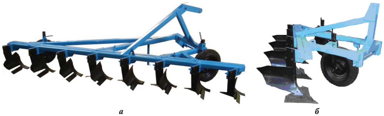
Рис. 3. Новые плуги для агрегатирования с энергонасыщенными тракторами: а – ПБС-8У; б – ПБС-5У
