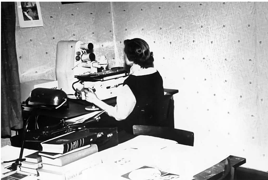
Foto 16: Esimene mikrofotomeeter MF-2 saabus 1960. Selliseid fotomeetreid kogunes nende kasutamisaegastu lõpuks Tallinna Tähetorni kolm, lisaks veel üks registreeriv MF-4. Neid kasutati Tartu fototeegi plaatidelt tähekujustistele vastavate tumenemiste mõõtmiseks. Iga aktiivse astronoomiahuvilise kirutamata kohustuseks oli saada vähemalt ühe tähe heleduskõver ja eesmärgiks leida ka mõni uus muutlik täht.
