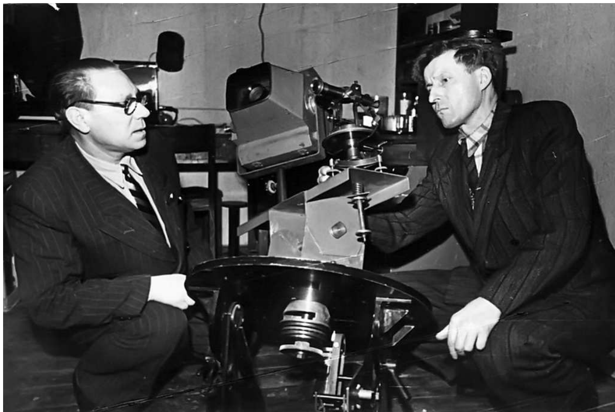
Foto 12: Aparaadiehitusega tegelesid mitmed Tallinna amatöörid. Pildil aerofotokaamera AFA kohandamine astronoomilisteks vaatlusteks (Toom, Leis).
