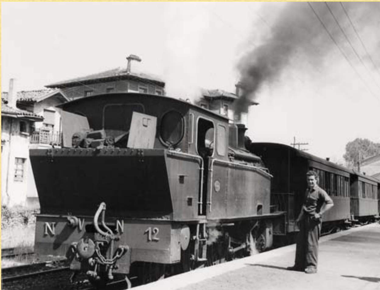
12 ZENBAKIKO LOKOMOTORA ZORNOTZAKO GELTOKIAN. IKATZ BRIKETEZ GAINEZKA DAGOEN TENDERRA IKUSTEN DA. ARGAZKIA, L. G. MARSHALL. LOCOMOTORA N° 12 EN LA ESTACIÓN DE AMOREBIETA. SE APRECIA EL TÉNDER REBOSANTE DE BRIQUETAS DE CARBÓN. FOTO, L. G. MARSHALL.
