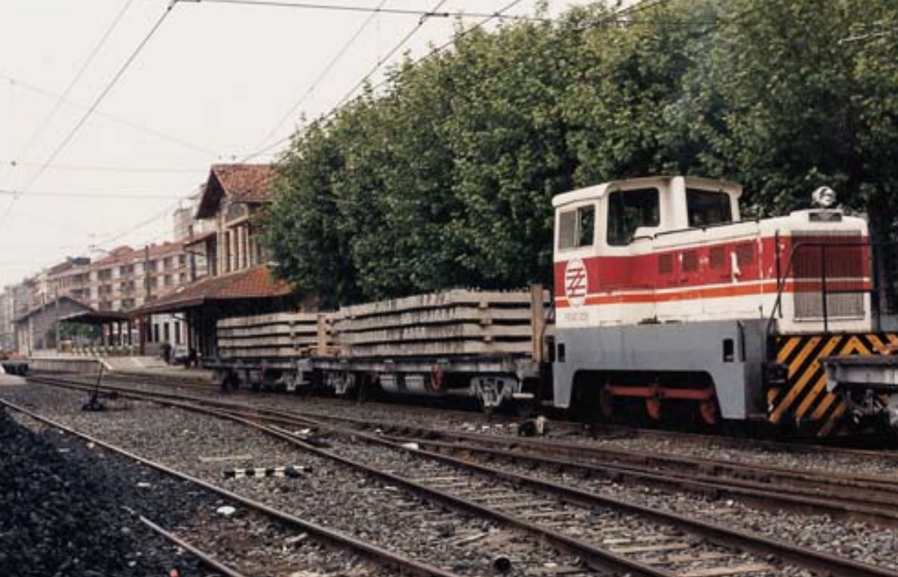
1300 SERIEKO DIESEL LOKOMOTORAK BERMEOKO LINEAN LANEAN ARITU IZAN DIRA BIDEA BERRIZTATZEKO ETA ELEKTRIFIKATZE LANETAN. ARGAZKIA, JUANJO OLAIZOLA. LAS LOCOMOTORAS DIESEL DE LA SERIE 1300 HAN TRABAJADO EN LA LÍNEA DE BERMEO DURANTE LAS OBRAS DE ELECTRIFICACIÓN Y EN LAS RENOVACIONES DE VÍA. FOTO, JUANJO OLAIZOLA.
