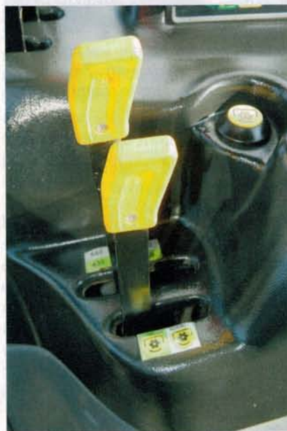
Prędkość WOM wybiera się dwoma dźwigniami. Do włączania wału wykorzystuje się przycisk.
