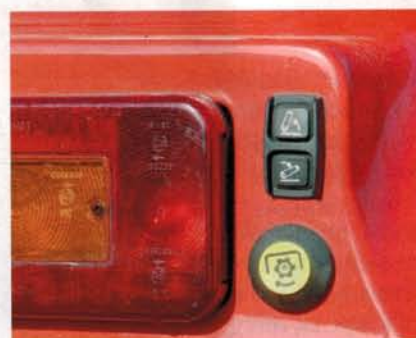
Zewnętrzne przyciski do sterowania TUZ i WOM ułatwiają zaczepianie maszyn rolniczych.
