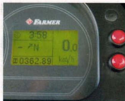
Niewielki wyświetlacz informuje m.in. o prędkości jazdy i obrotach WOM.
