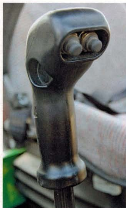
Przyciski do zmiany przełożeń pod obciążeniem są na dźwigni.
