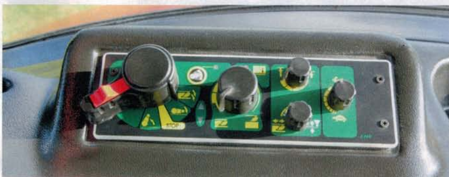
Elementy sterowania podnośnikiem umieszczone są na prawej konsoli. Sterowanie TUZ pochodzi od firmy Bosch.
