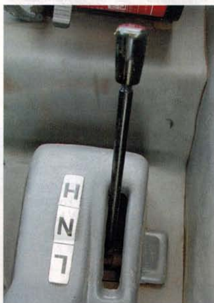
Reduktor zlokalizowany jest po lewej stronie fotela traktorzysty. Zmiana przełożeń nie sprawia trudności.
