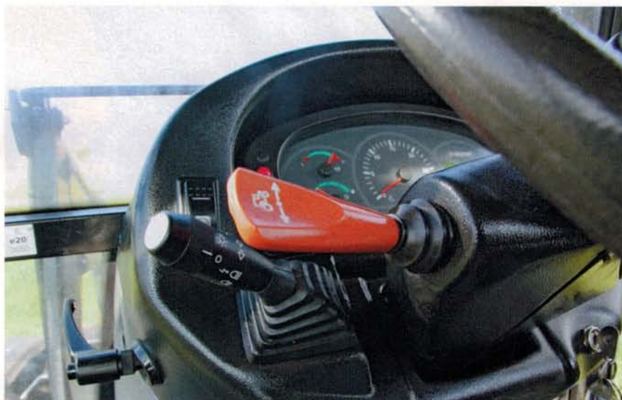
Rewers elektrohydrauliczny pozwala na zmianę kierunku jazdy bez użycia sprzęgła. Dźwignię rewersu można obsługiwać bez odrywania ręki od kierownicy.
