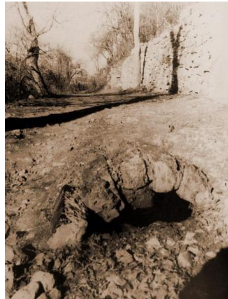
F.8.1.58 Material rezidual cunoscut sub numele de „Băren”(urii), în limbajul metalurgiei tilor, rezultat la topirea minereului. Pentru îndepărtarea acestora era necesară demolarea cuptorului și apoi reconstruirea lui, operațiuni care durau câteva luni, timp în care producția uzinei se diminuea considerabil. Foto. iulie 2005
