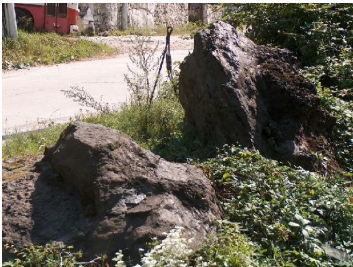
F.8.1.58 Material rezidual cunoscut sub numele de „Băren”(urii), în limbajul metalurgiei tilor, rezultat la topirea minereului. Pentru îndepărtarea acestora era necesară demolarea cuptorului și apoi reconstruirea lui, operațiuni care durau câteva luni, timp în care producția uzinei se diminuea considerabil. Foto. iulie 2005
