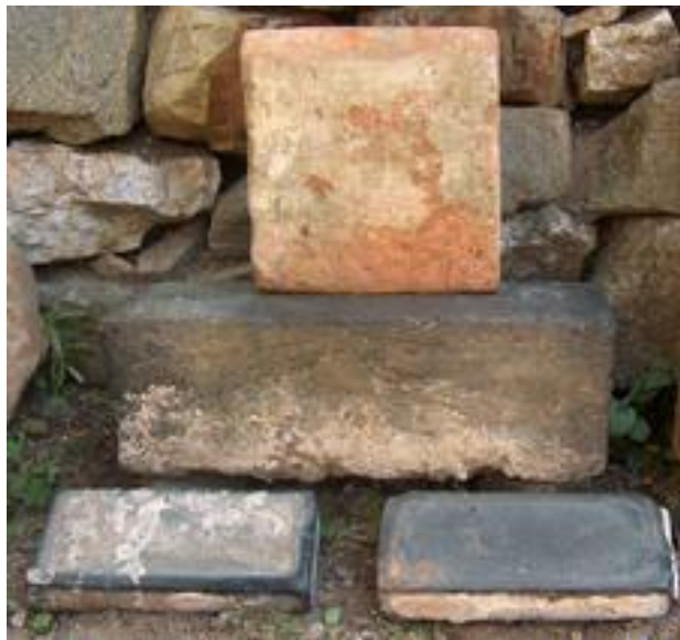
F.3.105 C r mizi, blocuri, dale din ceramic i material de topitorie, folosite pentru construc ii i plac ri.
