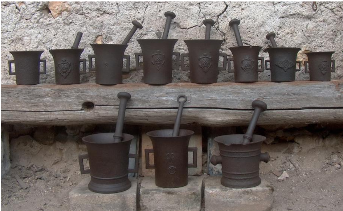
F.8.1.74 Pive (mojare) de font pentru sf râmarea probelor de minereu, sec. XIX. (Colec ia V. T utu)
