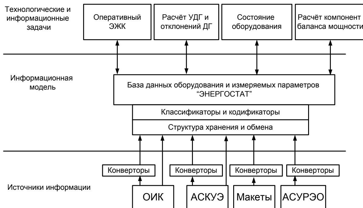
Рис. 3. Структурная схема функционирования компонент "Электронный журнал команд" и "Состояние оборудования".
