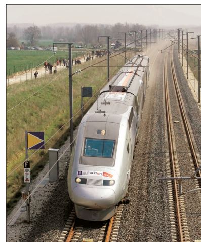
3. ábra Arra, hogy mi történik a nagysebességű vonatok haladása közben a vonat alatt és végén szolgáljon illusztrációként az AGV sebesség-rekordjáról készített felvétel. Látható, hogy a vonat végéhez közeledve a légnyomáskülönbség miatt az igen erős örvénylés a jármű felől szívóhatást kelt. A nyomáscsökkenés miatt a pályáról a finom por, a víz és a hó a legkisebb réseken, nyílásokon, tömítetlenségen át a járműbe juthat (Fotó: Alstom)
