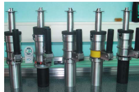
Рис. 9. Импульсные однолитровые огнетушители дальностью до 16 м при распылении воды (опытно-промышленная партия изготовлена в Швейцарии на фирме «Pugotex» по лицензии автора)
