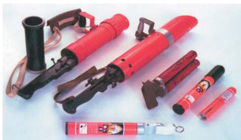
Рис. 4. Импульсные огнетушители: а – карманный вместимостью 0,15 л и радиусом тушения до 2 м; б – автомобильные вместимостью 0,33 л и радиусом тушения до 4 м – одноразовый с черной ручкой и многоразовый со сменными контейнерами со светлой ручкой; г – 3-ствольный огнетушитель со стволами вместимостью 0,33 л каждый; д – профессиональный вместимостью 2 л и радиусом тушения от 10 до 17 м – с косым срезом ствола для заряжания природными материалами (грунт, песок, грязь, пыль, вода, снег и пр.); е – профессиональный огнетушитель контейнерного заряжания, контейнер емкостью 1л - жидкие, гелеобразные, пенообразующие огнетушащие составы.
