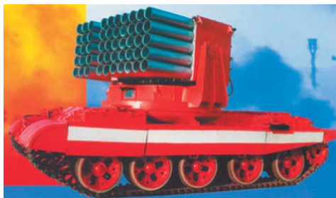
Рис. 2. Импульсная 50-ствольная башенная установка типа «Импульс-3М» на шасси танка Т-62, выпущенная в 1991 г. опытной партией (32 машины)
