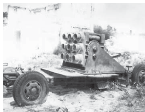
Рис. 6. Лафетные многоствольные установки: а – многоствольная установка на прицепе; б – 25-ствольный модуль минометного типа; в – 30-ствольный безоткатный модуль
