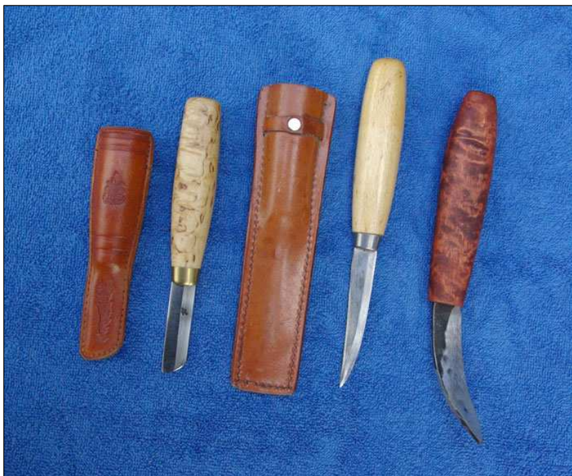
Kuva 61 Rööriveitsi, kapeateräinen puukko ja viluntekijän puukko ovat soitinrakentajien työkaluja.
