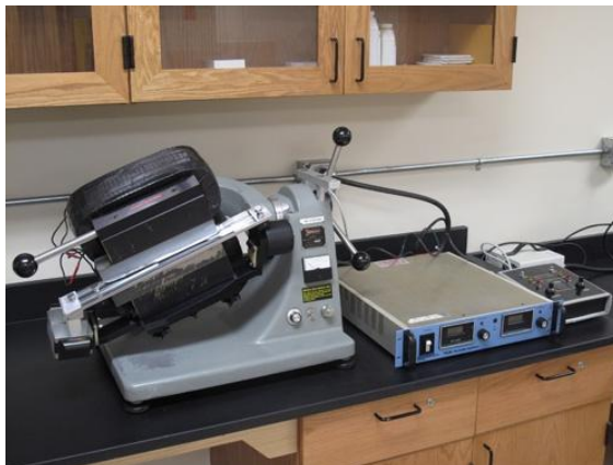
Figura 5: Separador magnético Frantz Isodinamic LB-1
