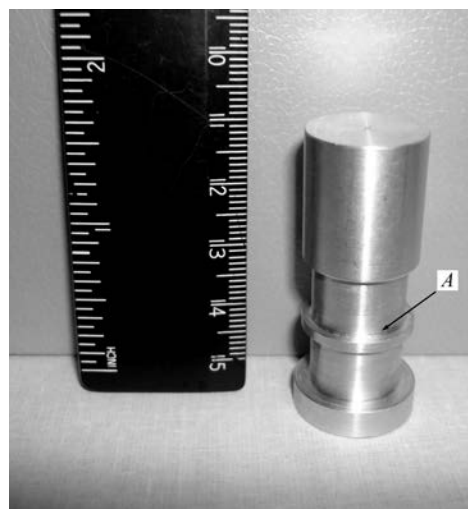
Рис. 5. Образец (А – поясок, на который напыляли покрытие)
