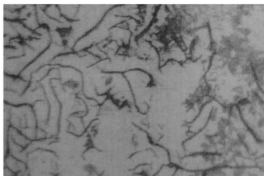
Рис. 1. Микроструктура чугуна СЧ20 на нетравленном шлифе (×400)
