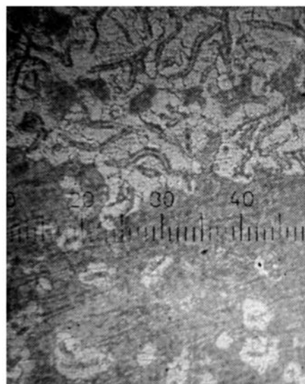
Рис. 3. Микроструктура границы окисленного слоя с основой чугуна на травленном шлифе ( \times 400 )
