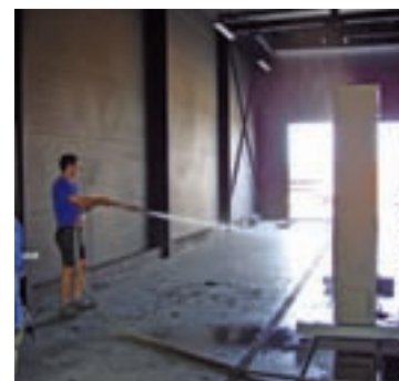
Nassprüfraum Damp-testing site
