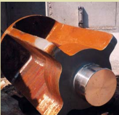
Detail draaiarm en taatslager tijdens uitvoering.
