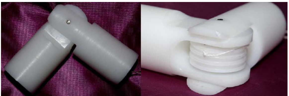
Figuur 9. Armgewricht met katrollen en veren
