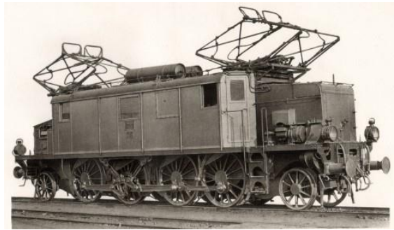
Figura 33: a sx - mensola con sospensione trifase in curva sopraelevata; a dx - locomotiva elettrica a c.a. trifase E.432 (1926)
