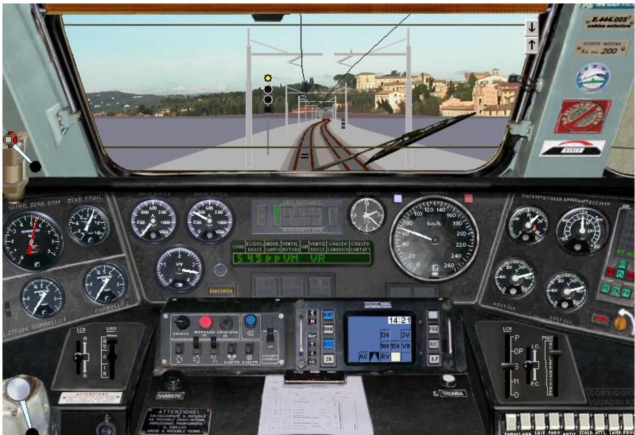
Figura 5: l'interfaccia RSC a 9 codici (in basso) sul banco di manovra di una locomotiva. In questo momento viene data l'indicazione di codice 180 (tramite luce bianca), che fornisce l'informazione sull'aspetto del segnale che si sta per incontrare.
