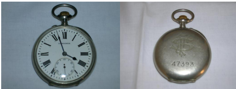
Foto 11: orologio ferroviario Longines di tipo ordinario – in alto a sx è la poussette per la regolazione dell'ora
