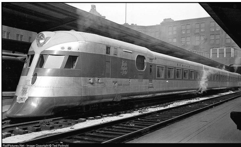
Foto 1: Il Comet treno del tipo streamline a trazione diesel elettrica costruito nel 1935 per la New York, New Haven and Hartford Railroad dalla Goodyear-Zeppelin Company.
