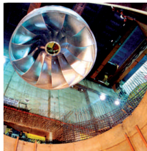
Ilustracija 5 Turbinsko kolo Francisove turbine HE Itaipu
