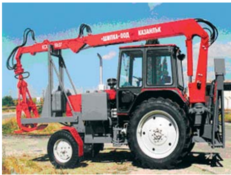
Сн. 4. Хидравличен стрелови кран „КСХ 80.59-07“: товароподобен момент - 73 kNm; максимална дължина на стрелата - 5.6-7.4 т; максимална височина на повдигане - 8.3 т; телескопично удължаване - 0.7-1.6 т; ротор с неограничено завъртане; грайфер - 0.35 т 2 ; транспортна височина - 2 т; транспортна ширина - 2.3 т; общо тегло с оборудването - 1550 kg. Дневна производителност - 100-150 т 3
