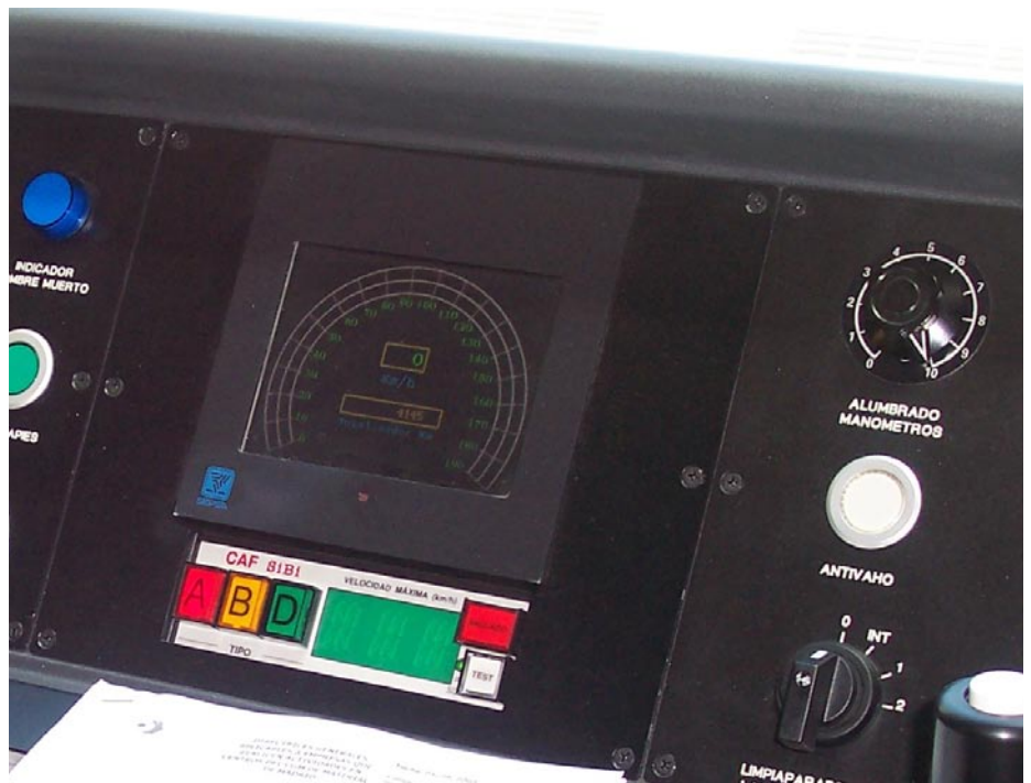
Detalle de la cabina de conducción del coche motor 9-598-002-4 en la que se aprecia el SIBI.
