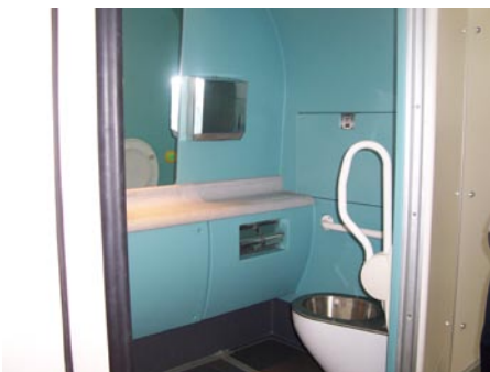
Aseo del coche M1c adaptado para facilitar el acceso a personas de movilidad reducida (PMR).
