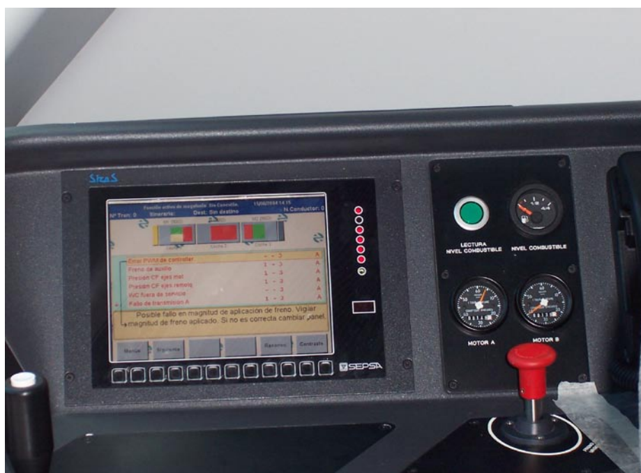
Detalle de la terminal de información para el conductor del SICAS (Sistema Integrado de Control de Auxiliares SEPSA).
