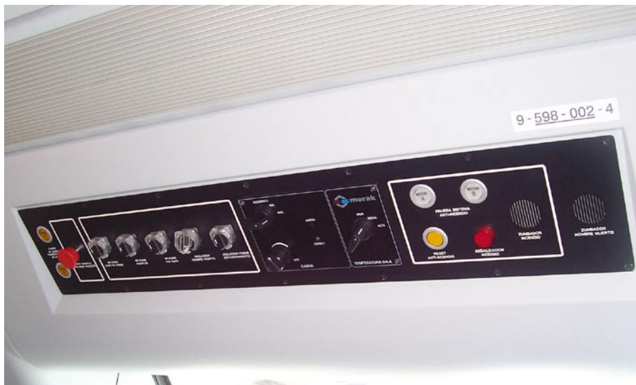
En la parte superior de la cabina el maquinista puede regular la temperatura de la misma de forma independiente a la de las salas de viajeros.
