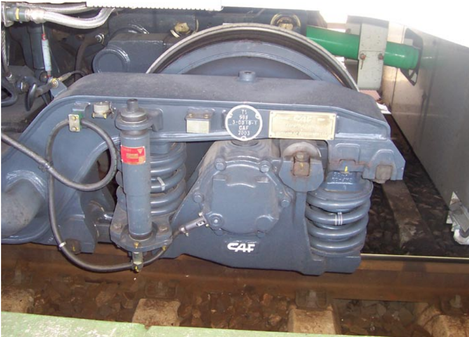
Detalle del eje motor y del árbol cardán (en color verde).
