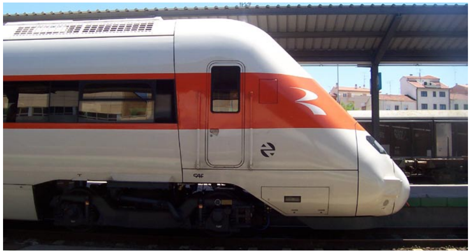
Testero aerodinámico del coche motor 9-598-502-3. La puerta de acceso desde el exterior a la cabina se encuentra en el lado derecho, es de una hoja y apertura manual. Los equipos de refrigeración se encuentran en el techo en vez de bajo el bastidor. Al reducirse el nivel de suciedad y la temperatura se aumenta la eficacia de los equipos.
