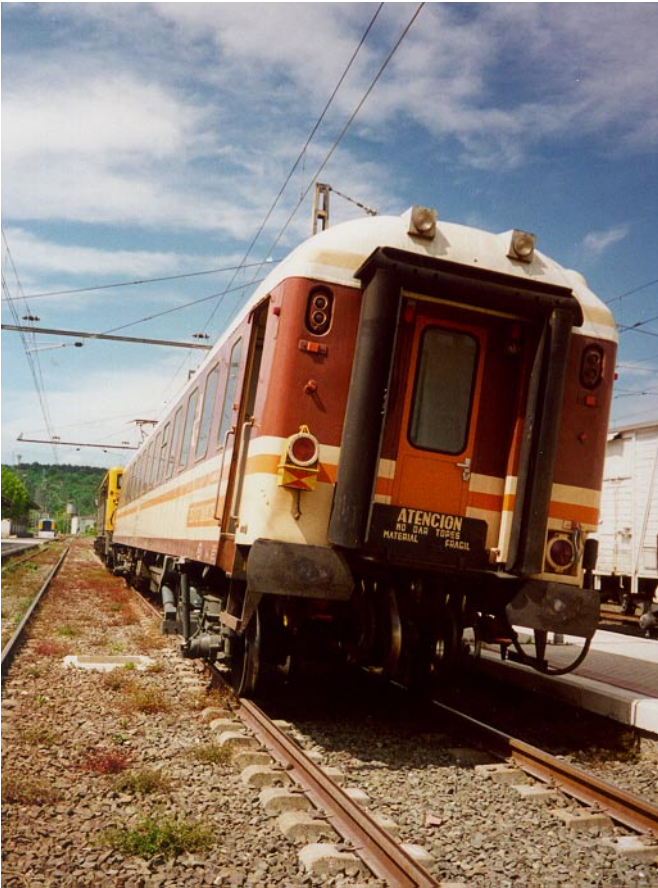
Arriba: Prototipo de bogie basculante instalado en Coche Laboratorio. Cortesía CAF.
