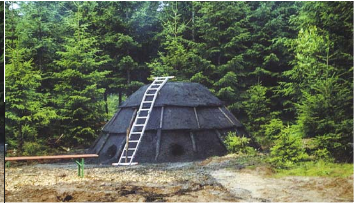
Der fertige Meiler ist mit Lösch abgedeckt. Deutlich erkennbar sind die Stege zur Wartung des Meilers und die Zuluftlöcher zum Anfachen des Meilers, die Leiter ist angestellt zum Befüllen der „Fülle“ mit Zündkohle.
