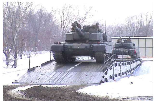
橋梁性能試験（90式戦車の連続通行）
