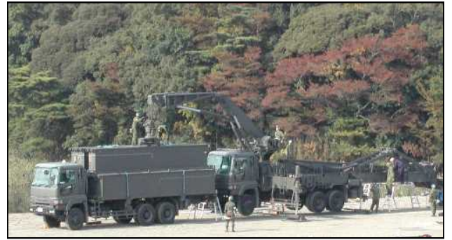
作業性能試験（橋節組み立て）
