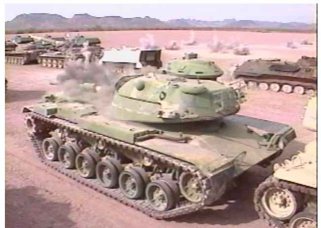
写真3 米国射撃試験（総合威力試験）における実子弾弾着状況
