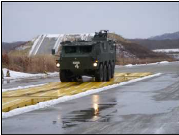
耐振動・耐衝撃性能確認試験（札幌試験場）
