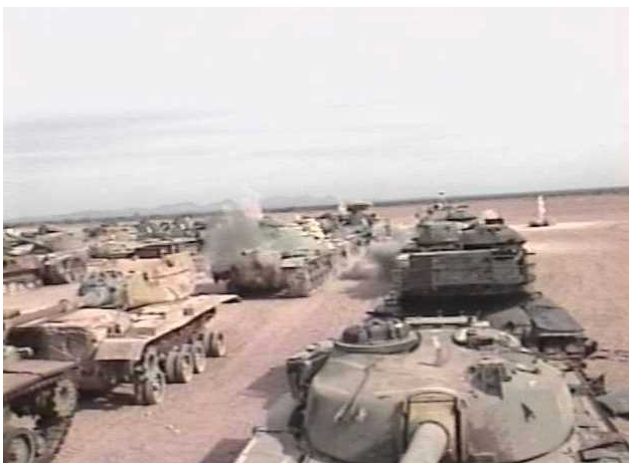
写真3 米国射撃試験（総合威力試験）における実子弾弾着状況
