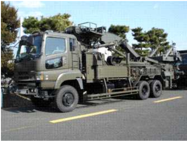
新架橋（架設車）
