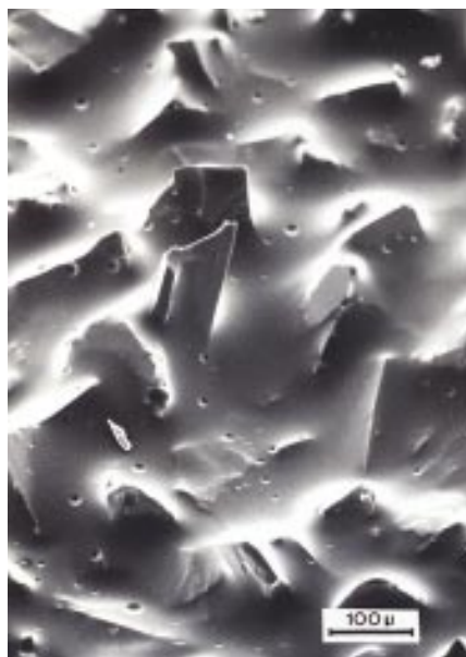
Fig. 12. SiC paper 220 Grit (FEPA), SEM
