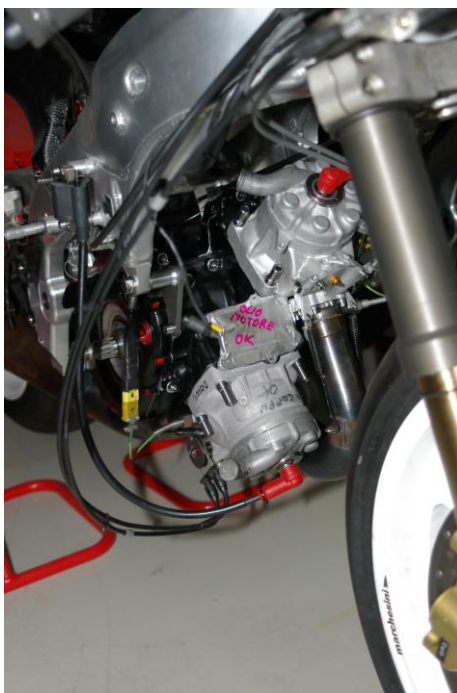
Immagine 2 – Motore R250GP 2005. Dall'immagine, è possibile osservare la configurazione a V di 90° del motore.
