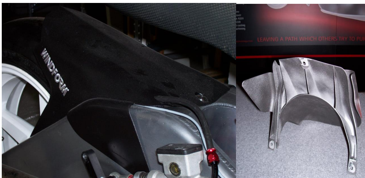
Immagine 10 – Parafango posteriore R250GP. Realizzato in Windform® XT e successivamente verniciato ed utilizzato in pista. Notare, nell'immagine a destra, il passaggio tubo posteriore ricavato direttamente dalla geometria del parafango.
