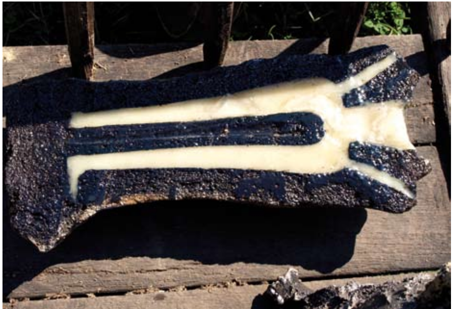
En gennemsåret kanonform, hvor man kan se kanonen opbygget i voks.
