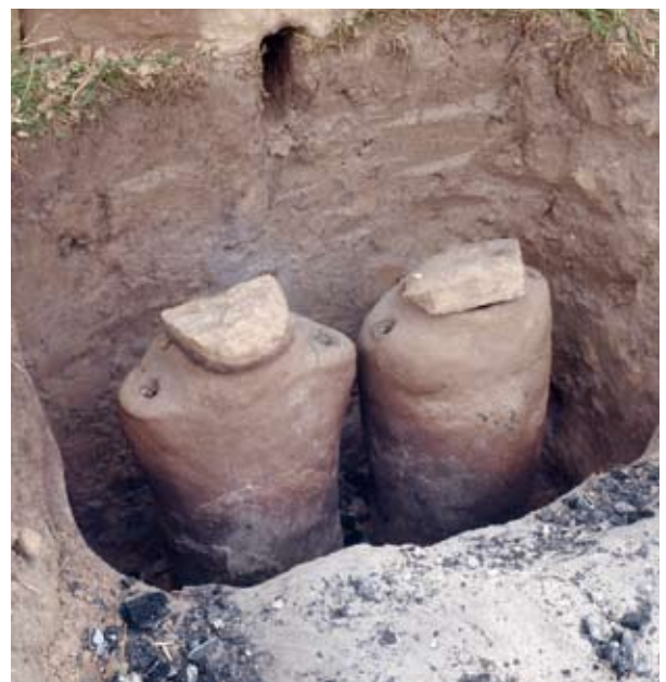
To kanonforme varmes igennem inden støbning og for at brænde de sidste voksrester ud.
