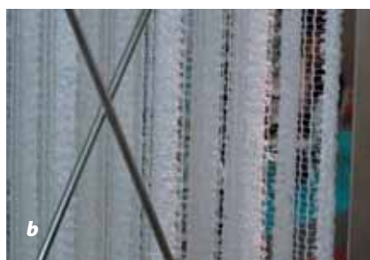
Joonis 3. Õhustatavate biofiltrite uudne täitematerjal Saksamaa firmalt Cleartec Water Management GmbH : a tekstiil-biokilekandja moodul (alumisel korrusel paistavad peenmullõhustid), b biokile kinnitub roostevabale raamile pingutatud sünteetilise kanga külge
