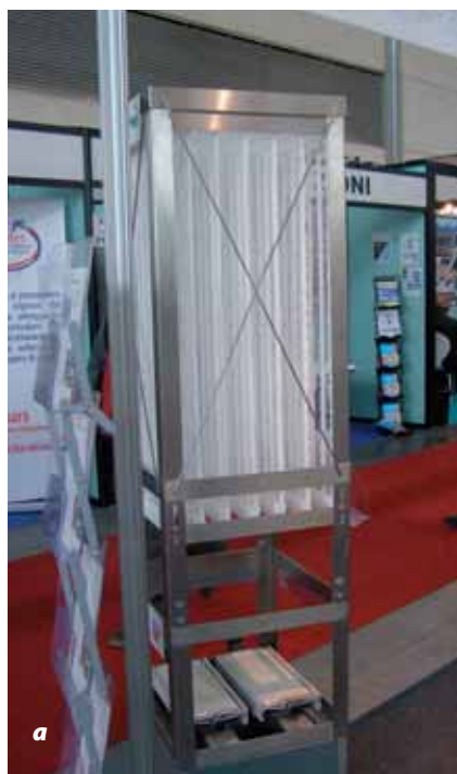
Joonis 3. Õhustatavate biofiltrite uudne täitematerjal Saksamaa firmalt Cleartec Water Management GmbH : a tekstiil-biokilekandja moodul (alumisel korrusel paistavad peenmullõhustid), b biokile kinnitub roostevabale raamile pingutatud sünteetilise kanga külge
