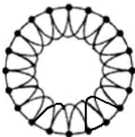
Rys 2.2.1 Schemat jednowymiarowej sieci regularnej. Węzły łączą się z sąsiadami pierwszego i drugiego rzędu. Źródło: [8].
