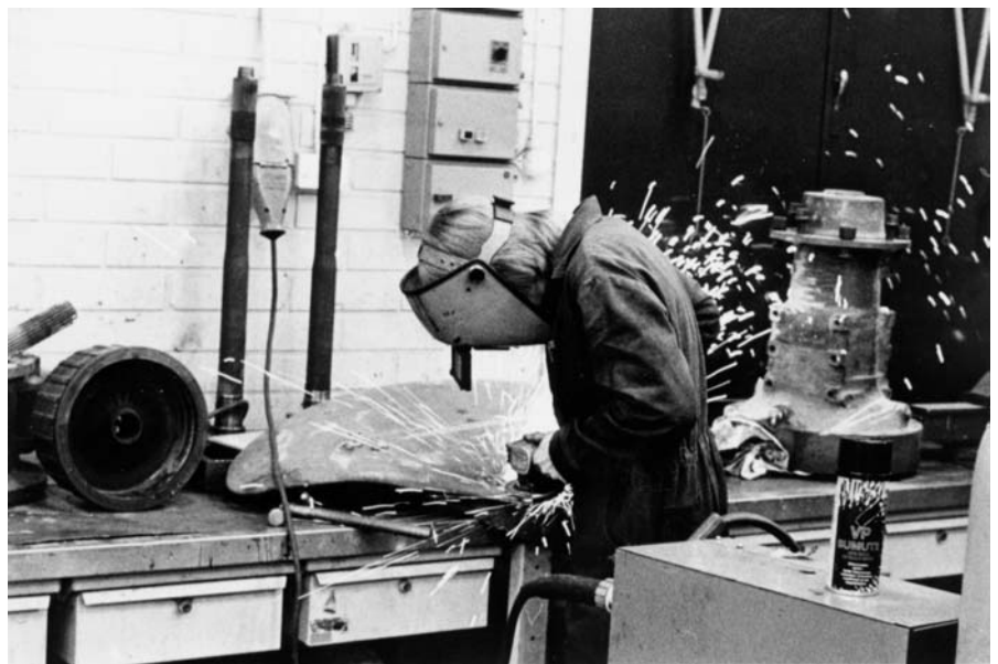
Petäjäveden kotiteollisuuskoulun (nyk. Keski-Suomen käsi- ja taideollisuusoppilaitos) metalliosaston oppilas Juhani Järvinen hiomassa kulmahiomakoneella, 1983. Kuva Seija Heinänen, Suomen käsiyön museo
