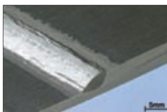
8. ábra: Négy órától 20 percre csökkent a hegesztési ciklusidő – gáz távvezeték hegesztése
