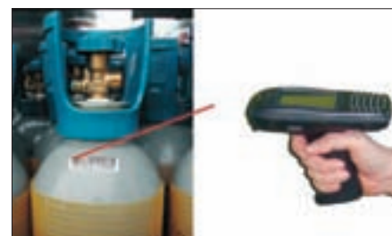
10. ábra: A palackok „nyomonkövetése” vonalkódos rendszerrel
