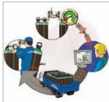
9. ábra: Gázellátó rendszer távfelügyeletének elve
