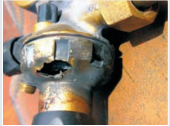
11. ábra: Helytelen tömítés (gumi) alkalmazása miatt bekövetkezett káreset oxigén nyomáscsökkentőnél
