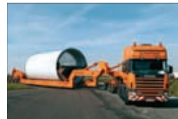
8. ábra: Egy acél toronyszekció bölcsőkocsis szállítása
