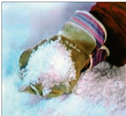
3. ábra: Szárazjégpellet tisztításhoz
