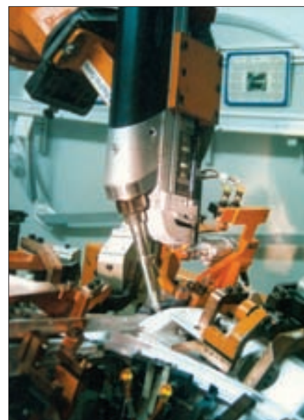
9. ábra: A Fronius LaserHybrid hegesztőfej jó pozicionálhatóságot biztosít a lézersugár és a hegesztőív és számára a munkadarabon
