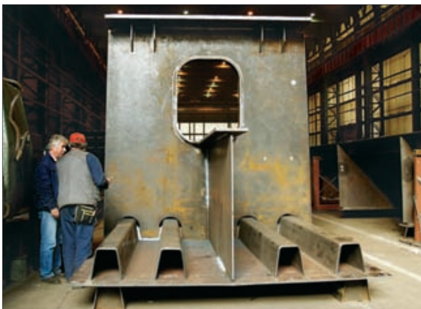
8. ábra: A hossztartós középső pályaelem összeállítása
