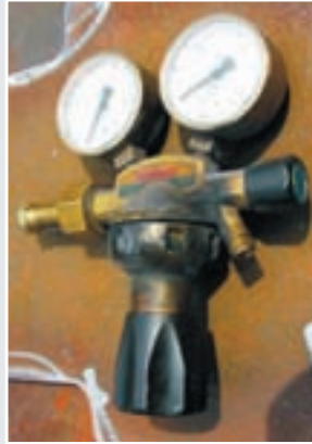
11. ábra: Helytelen tömítés (gumi) alkalmazása miatt bekövetkezett káreset oxigén nyomáscsökkentőnél
