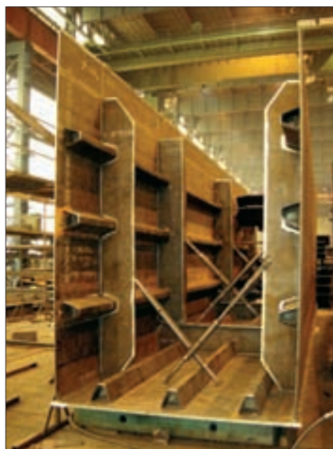
9. ábra: A főtartó összeállítása
