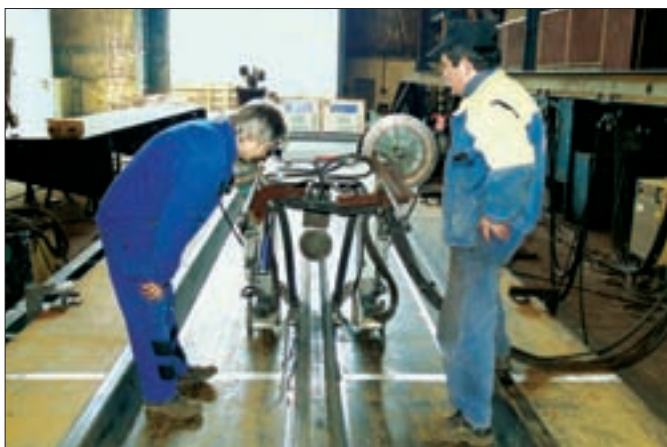
5. ábra: A trapézbordák hegesztése kétféjes automatával
