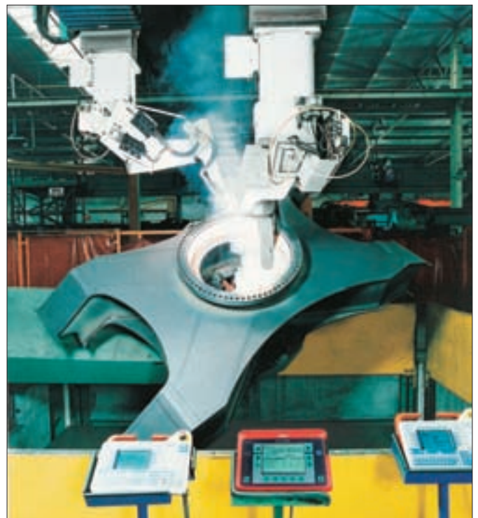
7. ábra: Szalaghuzalos hegesztés főleg nagy alkatrészek hegesztéséhez, amik munkadarab-befogó szerkezetekkel mozgathatók
