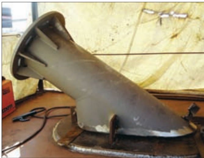
19. ábra: A kábel-védőcső hegesztéshez előkészítve
