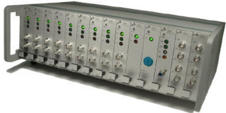
L'ICMsys8 est spécialement conçu pour répondre aux essais à réaliser lors des tests d'acceptation des transformateurs de forte puissance. Il reprend les fonctionnalités qui ont fait le succès de l'ICMsystem mais ajoute la possibilité de faire des mesures sur 8 voies en parallèle. Il existe aussi un certain nombre d'options comme les mesures RIV et les mesures acoustiques des DP.
